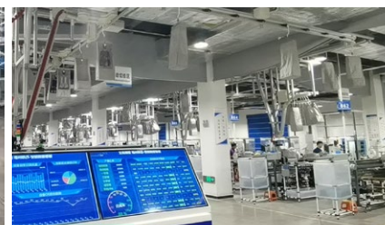
亳州联滔半成品线束 空中悬挂运输
